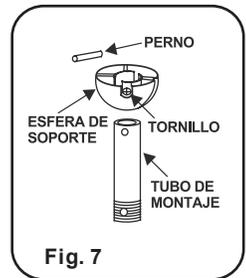
Paso 4. Meta cuidadosamente los alambres del ventilador hacia arriba a través del tubo de montaje. Atornille el tubo de montaje sobre el collarin hasta que los agujeros del tubo de montaje y el collarin queden alineados. Re-instale la chaveta y la chaveta de seguridad. Apriete bien os tornillos fijos con un desarmador de cruz. (Fig. 8)
