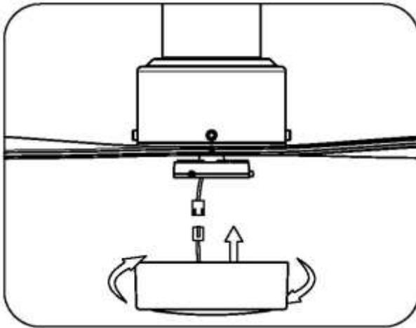
**Nota:** Uso de vatios en exceso de 75 inhabilitara su ensamblaje de luz del ventilador. Para restablecer la luz desconecte la corriente y corrija el uso de vatios.
